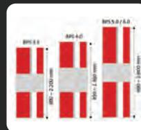
**Weitere Rollensatz-Varianten** bzw. Sonderanpassung der Prüfstandsmechanik an vorhandene Fundamente
